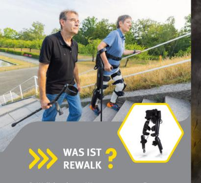
ReWalk ist ein am Körper getragenes Exoskelett. Es ermöglicht Menschen mit einer Querschnittlähmung durch motorisierte Hüften und Knie wieder aufrecht zu Stehen, zu Gehen, Kurven zu laufen und Treppen zu steigen. Über die Auswahl des gewünschten Betriebsmodus sowie die Unterarmgehstützen behält der Nutzer dabei die vollständige Bewegungskontrolle.
