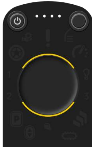
Abbildung 40. Anzeige der Steuerkonsole, dass der Joystick nach vorne oder hinten bewegt werden muss
