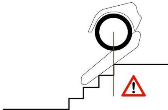
Abbildung 48. Wenn die Kante des letzten Tritttes von oben gesehen in der Mitte der Radachse ist, muss der Übergang zur oberen Ebene spätestens manuell ausgelöst werden!
