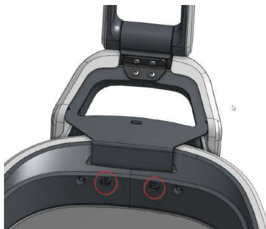
(b) Schraubenbefestigung Kopfstütze
