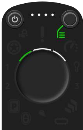
(a) Sitz-Menü, bei dem der Motor für die Verstellung der Rückenlehne ausgewählt ist.
