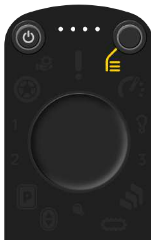
Abbildung 33. Das Menü-Symbol leuchtet gelb, wenn das Touchpad ausgeschaltet ist.
