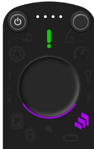
Abbildung 49. Der grüne Hinweis-Indikator zeigt auf, dass das Treppen-Ende erkannt und die hinteren Stützräder ausgefahren wurden
