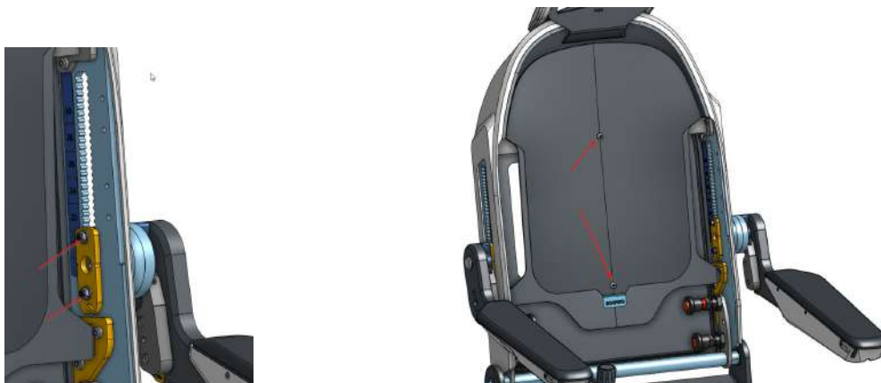
(a) Zu lösende Schrauben für die Entfernung der Armlehne
