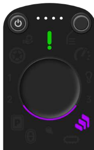
Abbildung 50. Der grüne Hinweis-Indikator zeigt auf, dass das Treppen-Ende erkannt und die hinteren Stützräder ausgefahren wurden. Wenn Du weiter nach vorne fährst, verschwindet der grüne Hinweis-Indikator. Jetzt bist Du genügend weit von der Treppe entfernt und kannst in den Fahrmodus wechseln.
