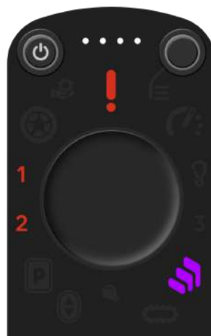
Abbildung 58. Anzeige Treppen-Ende-Erkennung Sensoren-Fehler auf der Steuerkonsole
