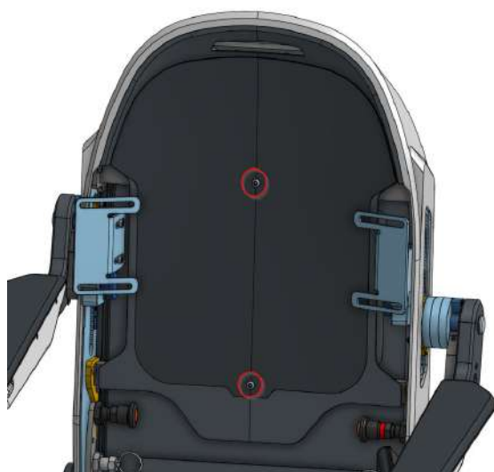
(a) Zu lösende Schrauben für die Entfernung der Textilabdeckung
