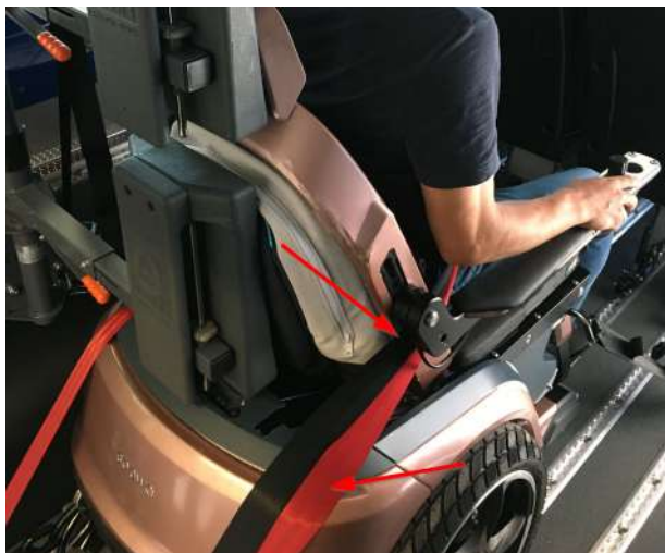
Abbildung 67. Korrekte Gurtführung des Becken- (rot) und 3-Punkt-Gurtes (schwarz) zur Sicherung des Benutzers
