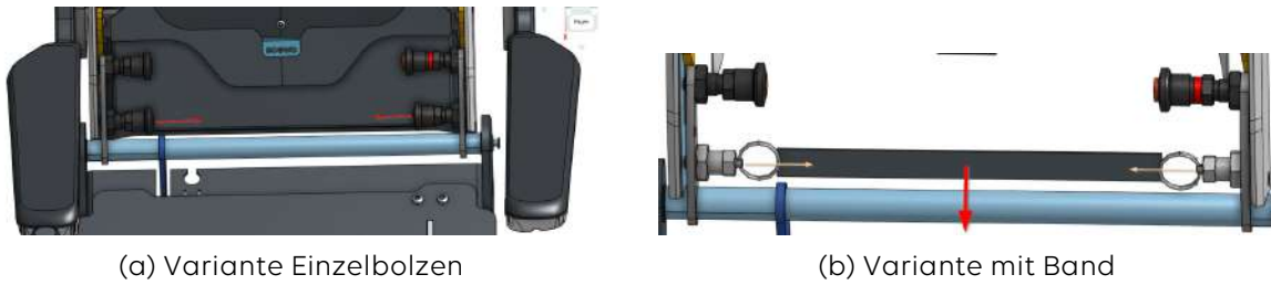
Abbildung 8. Zu entriegelnde Rastbolzen um Rückenlehne zu klappen
