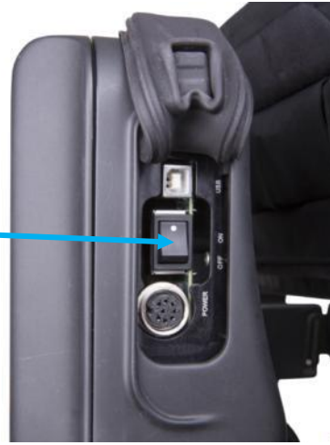
Detailbild des Ein/Aus-Schalters im Hüftpack.
