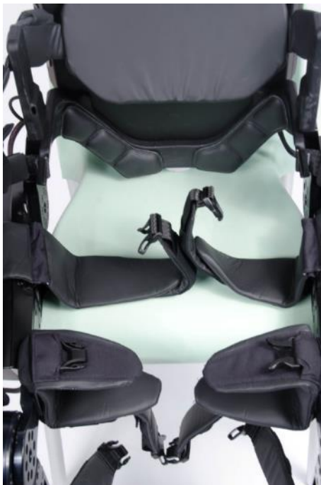
ReWalk mit offenen Gurten, die noch angepasst werden müssen
