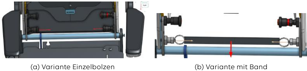
Abbildung 3.1.: Zu entriegelnde Rastbolzen um Rückenlehne zu klappen
