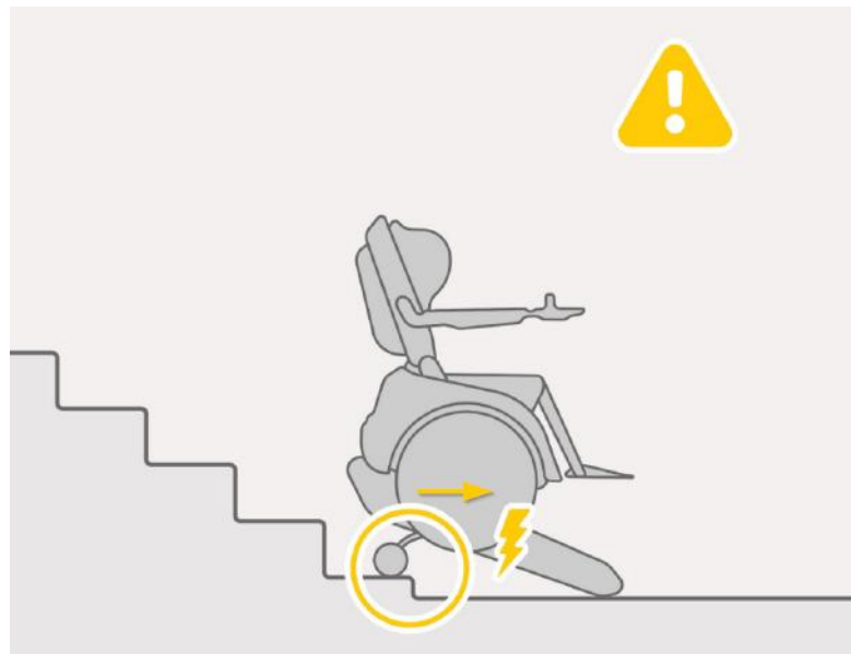
Abbildung 5.19.: Treppe mit gefährlichem, niedrigem, letzten Tritt unten
