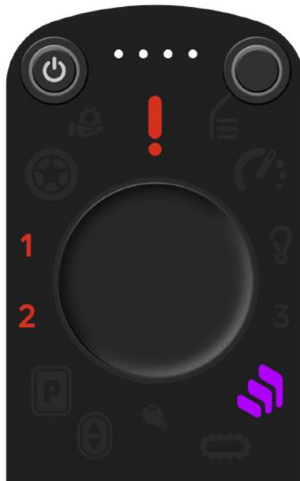
Abbildung 5.21.: Anzeige Treppen-Ende-Erkennung Sensoren-Fehler auf der Steuerkonsole
