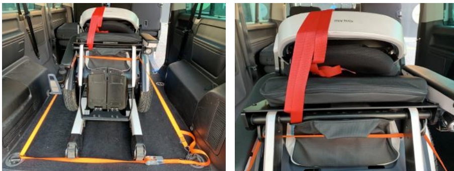
(a) Sicherung vorne
