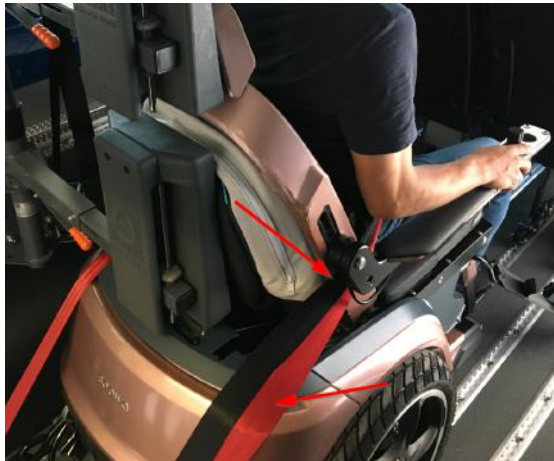
Abbildung 5.30.: Korrekte Gurtführung des Becken- (rot) und 3-Punkt-Gurtes (schwarz) zur Sicherung des Benutzers
