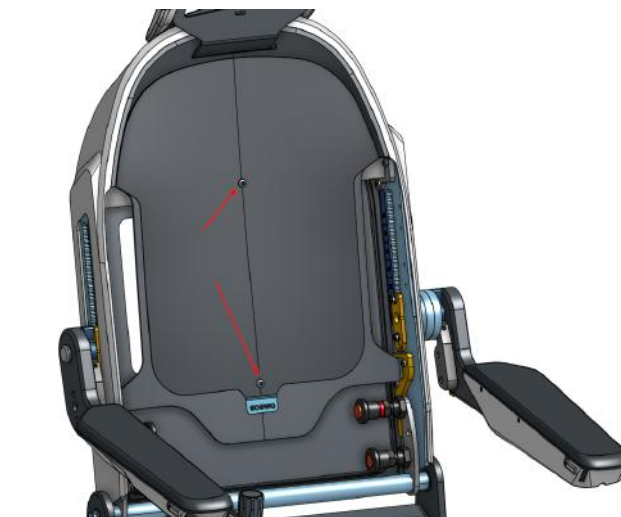
(b) Zu lösende Schrauben zur Entfernung des Rückenlehnen-Inlays
