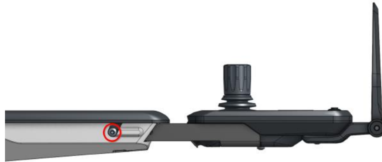
Abbildung 3.7.: Zu lösende Schrauben, um Position der Steuerkonsole zu verstellen (beidseitig lösen)
