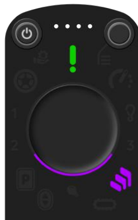
Abbildung 5.13.: Der grüne Hinweis-Indikator zeigt auf, dass das Treppen-Ende erkannt und die hinteren Stützräder ausgefahren wurden
