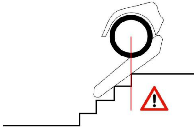
Abbildung 5.12.: Wenn die Kante des letzten Trittes von oben gesehen in der Mitte der Radachse ist, muss der Übergang zur oberen Ebene spätestens manuell ausgelöst werden!
