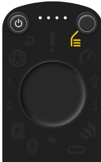
Abbildung 4.8.: Das Menü-Symbol leuchtet gelb, wenn das Touchpad ausgeschaltet ist.
