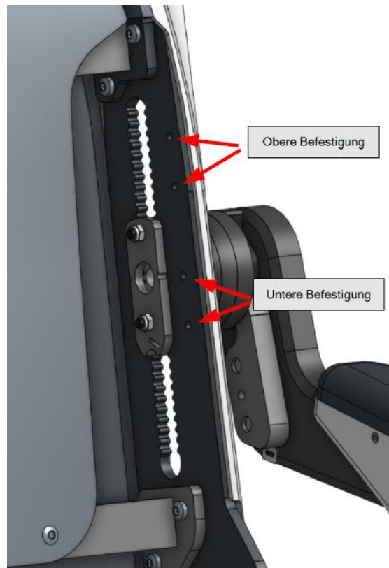
Abbildung 3.11: Befestigungslöcher für Rückenkissen-Halterungen (2 Ausgangs-Höhen)
