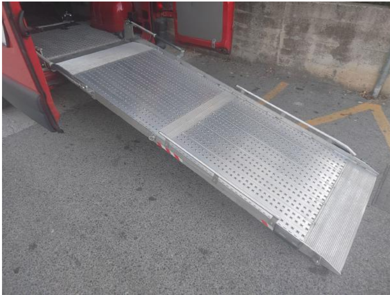
Abbildung 5.28.: Gefährliche, steile Klapprampe mit Schwellen oben
