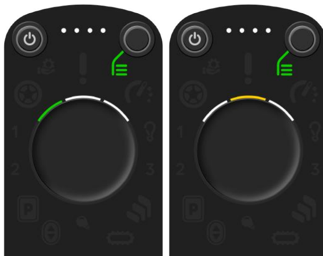
(a) Sitz-Menü, bei dem der Motor für die Verstellung der Rückenlehne ausgewählt ist. (b) Im Treppensteig Modus ist der Motor für die Sitzverstellung nicht verstellbar.
