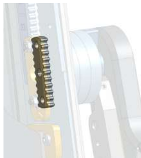
Abbildung 3.4.: Verzahntes Teil welches zur Höhenverstellung dient
