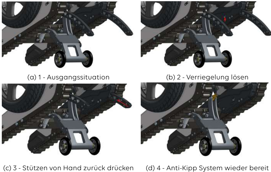
Abbildung 5.20.: Wieder Einfahren des Anti-Kipp Systems
