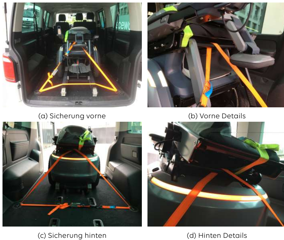
Abbildung 5.25.: Empfohlene Ladungssicherung des Rollstuhls Bro V1
