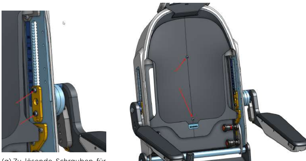
(b) Zu lösende Schrauben zur Entfernung des Rückenlehnen-Inlays
