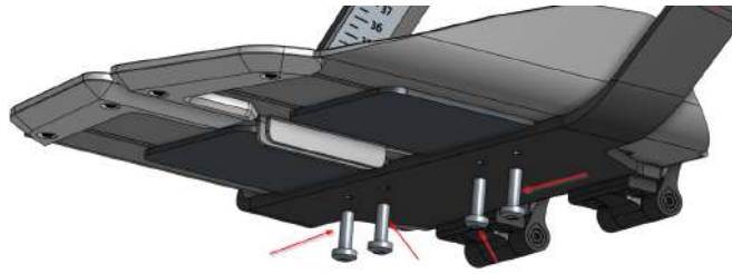
Abbildung 3.9.: Stellschrauben für die Fussplatten-Winkeleinstellung
