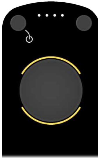
Abbildung 5.5: Anzeige der Steuerkonsole, dass der Joystick nach vorne oder hinten bewegt werden muss
